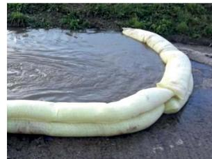
Abbildung 57: Einfach aber wirkungsvoll. Sperre mittels Wasserschutzschlauch.
