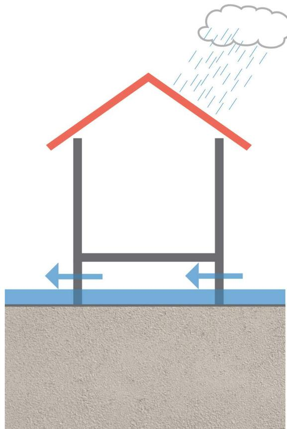
Abbildung 42: „Nasse Vorsorge“ durch Aufständigung des Gebäudes.
